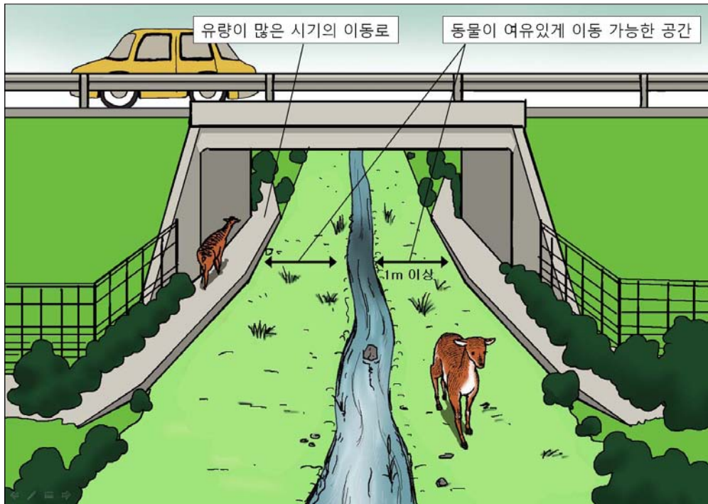
그림 2-19. 수로에 설치한 터널형 생태통로의 예시 (스케치)
