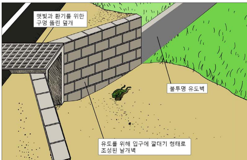
그림 2-24. 햇빛 투과형 양서·파충류 터널의 예시(입구부 스케치)
