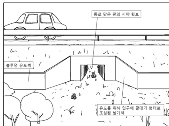
그림 2-23. 햇빛이 투과되지 않는 양서·파충류 터널의 예시(스케치)
